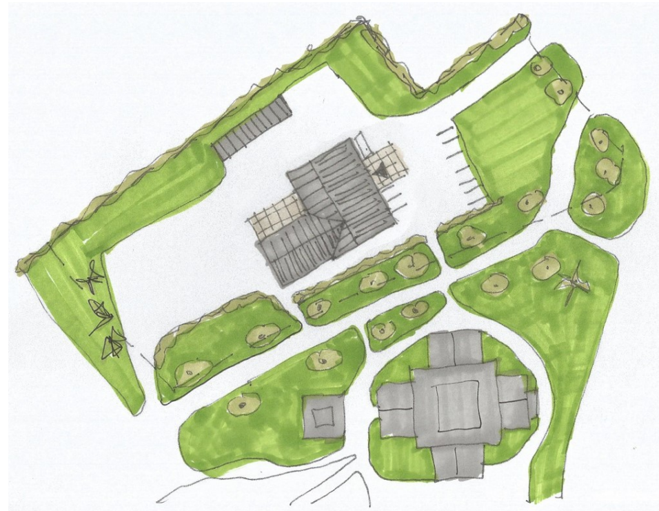
Ohjeellinen esimerkki tontin käytöstä liikerakentamiseen. Asiakasliikenne ohjataan tontin itäosista ja huoltoliikenne tontin länsiosista. Liikerakennuksen pihapiirin alue tulee pensasaidoilla rajata kirkon suuntaan. Huoltotoiminnot ja mahdollinen huoltorakennus on sijoitettava tontin pohjois- tai koillisosiin.
